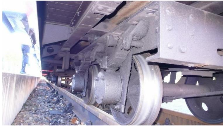
Ca. 1978 erhielten alle ehemaligen sächsischen Wagen der Parkeisenbahn Waldbahn-Drehgestelle. Dazu wurden zwei zusätzliche Querträger eingeschweißt. Die ehemalige Befestigung des alten Fahrwerks ist an den Löchern im Längsträger und der angeklebten Federaufhängung noch gut zu erkennen.
