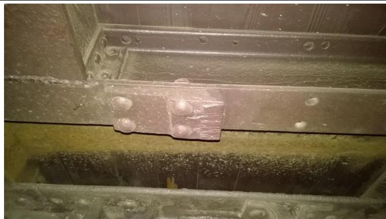
Hier eine Detailaufnahme der alten Aufhängung der Tragfedern, die bei dem Umbau auf Drehgestelle mit dem Schneidbrenner abgetrennt wurde.
