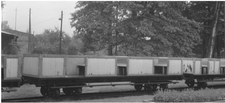
Um dem gestiegen Verkehr gerecht zu werden, baute das Raw Cottbus 1961 vier neue, offene Wagen. Diese waren von Anfang an vierachsig und mit 7,40 m auch etwas länger. Es kamen Waldbahndrehgestelle zum Einsatz. Der Fahrzeugrahmen ist eine Schweißkonstruktion. Rechts im Bild ein älterer Zweiachser.
