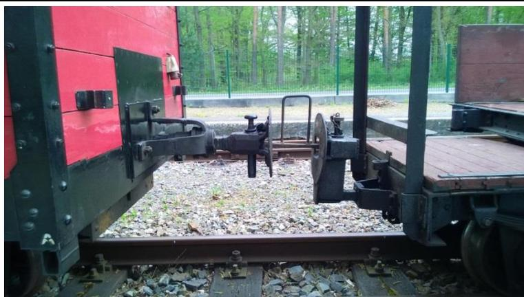
Hier wird der Höhenunterschied zwischen der eigentlich für 750 mm Spurweite bestimmten Trichterkupplung und der ursprünglichen 600-mm-Kupplung deutlich. Dieser beträgt 29 cm und kann nur mittels speziell angepasster Konstruktionen überbrückt werden. Rechts im Bild der „Plattenwagen“, ehemals Muskauer Waldeisenbahn.
