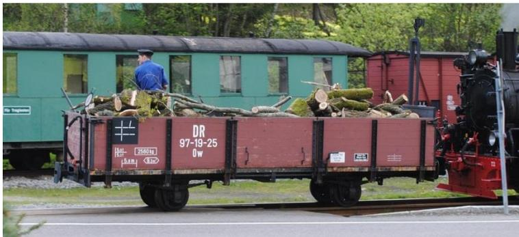
Dieses originale Exemplar (Achsstand 3,0 m, ohne Bremse, mit freien Lenkachsen ) ist heute bei der Preßnitzalbahn im Einsatz.
