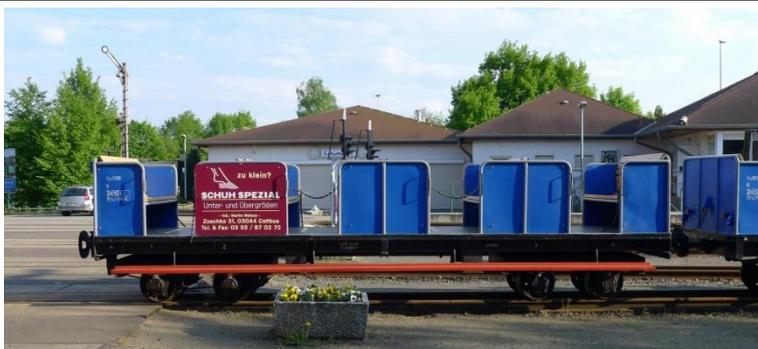
Ende der 1970er Jahre erfolgte eine weitere Veränderung: Die Wagen wurden von zwei auf vier Achsen umgebaut, indem sie Waldbahndrehgestelle erhielten. Die Aufbauten modernisierte man ebenfalls, statt Holz kam Blech zur Anwendung. So sind sie noch heute im Einsatz.
