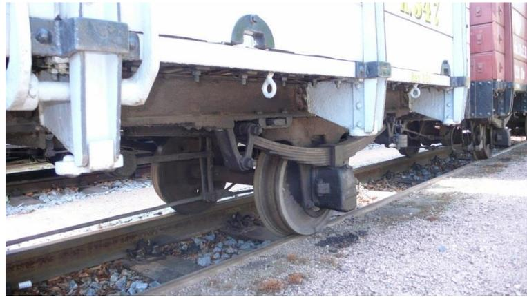
Das Einachs Drehgestell am sächsischen Originalwagen. Federaufhängung und Führungszapfen sind gut zu erkennen. Mit solchen zweiachsigen Fahrwerken waren die Cottbuser Wagen bis Ende der 1970er Jahre unterwegs, allerdings umgespurt von 750 mm auf 600 mm.
