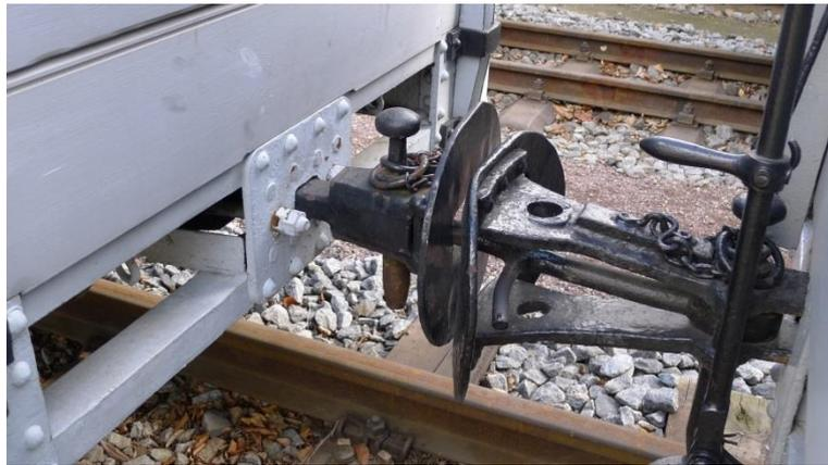
Die sächsische Trichterkupplung in der originalen Ausführung. Links der kurze Trichter mit dem glatten Schlitzpuffer, rechts der lange Trichter mit dem gewölbten Pufferteller und dem ausschwenkbaren Kuppelleisen. Die Pufferteller liegen dicht beieinander.
